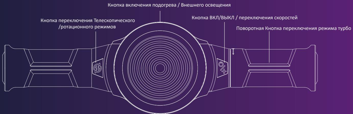
**Включение изделия:** нажмите и удерживайте кнопку "⊕" в течение 1,5 секунд, чтобы включить или выключить устройство. При включении индикатор кнопки и RGB-подсветка по обеим сторонам ручки загорятся одновременно.
